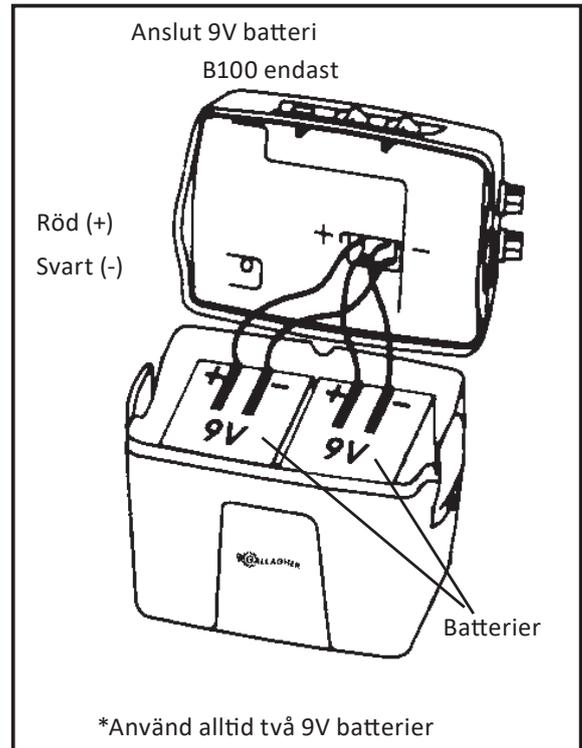
OBS! Koppla alltid ifrån batteriet (batterierna) när de inte används.
