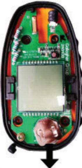
**Nota:** Assicurarsi che la guarnizione nera sia posizionata correttamente per fare in modo che Fault Finder sia a tenuta stagna.
