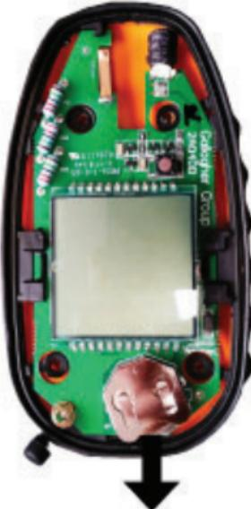
**Bemærk:** Sørg for, at den sorte pakning sidder pænt på plads for at sikre, at fejmåleren er vandtæt.
