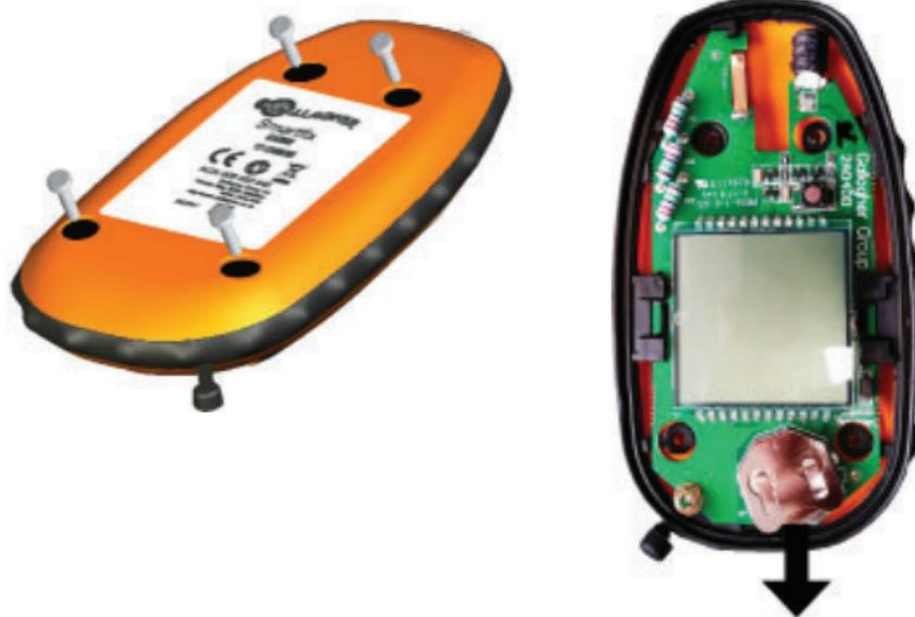
**Opmerking:** Zorg dat de zwarte afdichtring weer goed wordt geplaatst om te garanderen dat de Fault Finder waterdicht is.
