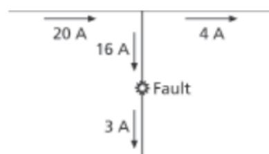
2. Seguendo la direzione della corrente effettuare letture a distanza di 50 - 100 m o in corrispondenza delle giunzioni lungo la recinzione.
