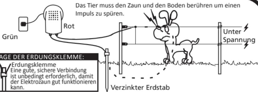
Installieren Sie den Erdstab in einer Mindestdistanz von 10 m von anderen Erdpfählen für Stromzuleitungen, von unterirdischen Telefon- und Stromkabeln, usw.
