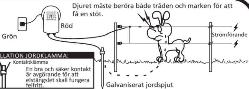
Placerar jordspjut minst 10 meter från andra elektriska installationers jordningssystem, kraftkablar, telefonledningar eller dylikt.
